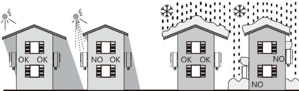
Asegúrese de que el inversor esté instalado en el lugar correcto. El inversor no se puede instalar cerca al maletero.
