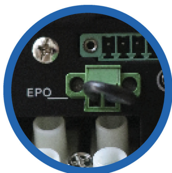
Apagado de Emergencia (EPO)
