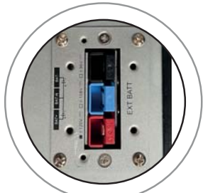
Conector de banco de baterías
