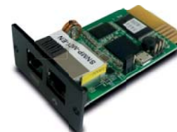
Tarjeta opcional: EMD (Dispositivo de monitoreo ambiental)
