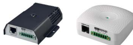
Tarjeta opcional: EMD (Dispositivo de monitoreo ambiental)
