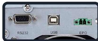
Puertos de comunicaciones externas / apagado de emergencia
