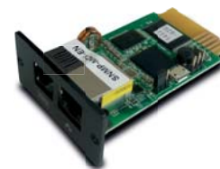
Tarjeta opcional: EMD (Dispositivo de monitoreo ambiental)
