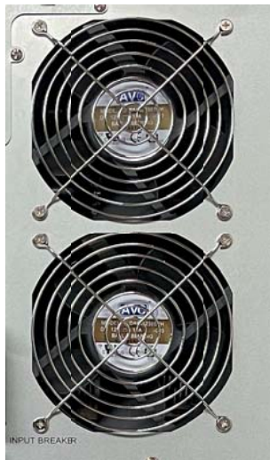
Velocidad de ventiladores controlado por nivel de carga
