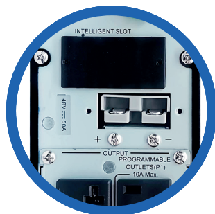
Entrada banco de baterías externas
