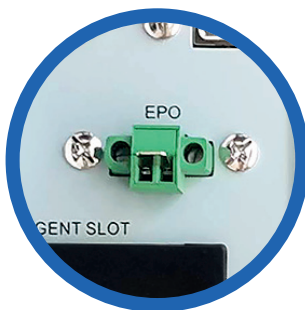
Apagado de emergencia (EPO)
